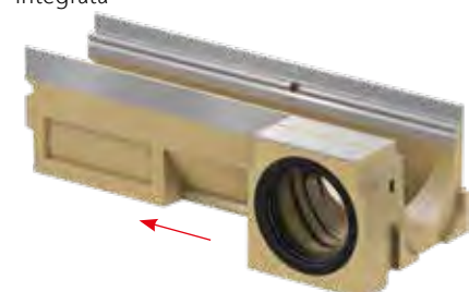
Collegamento con scarico laterale su elemento da 0,5 m tramite preforma aperta adattatore e testata con guarnizione integrata
