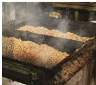
L'espansione e la fusione delle sostanze cerose avvengono all'interno di stampi metallici, grazie a vapore a 380°C.
