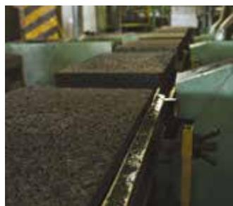
La squadratura del blocco, il taglio, la calibratura e la depolverazione, permettono di ottenere pannelli squadrati e planari, così da facilitarne la posa.
