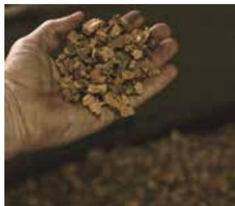
La separazione delle impurità e delle parti legnose avviene attraverso setacci in serie. Segue la riduzione a granulo.
