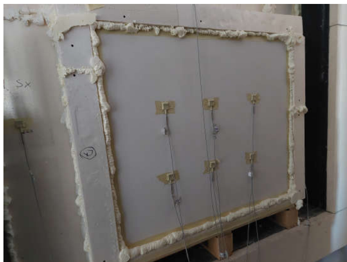
Immagine 5: Collocazione sensori a contatto sul lato freddo del provino
